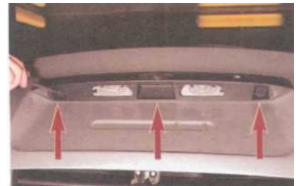
...крестообразной отверткой отворачиваем три самореза крепления накладки крышки багажника...
