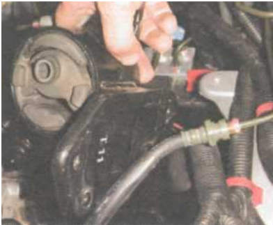
Снимаем левую опору силового агрегата.
