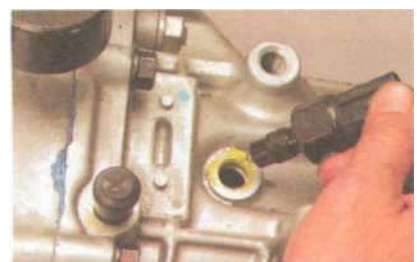
Ключом «на 24» отворачиваем выключатель...
