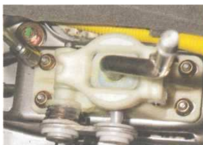
Тросы привода управления коробкой передач: 1 — трос выбора передач; 2 — трос включения передач; 3 — резиновый уплотнитель; 4 — прижимная пластина
