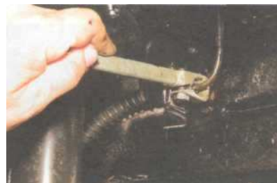
Ключом «на 11» (для тормозных трубок) отворачиваем штуцер тормозной трубки. Поддев отверткой...
