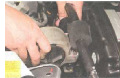
Снимаем опору с двух шпилек.
