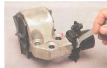
Ключом «на 12» отворачиваем болт крепления кронштейна демфера к опоре.
