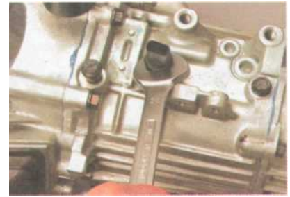
Ключом «на 24» отворачиваем выключатель...
