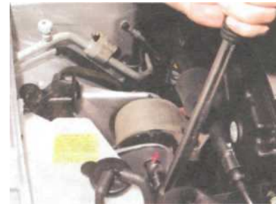
Головкой «на 17» ослабляем затяжку болта крепления опоры к кронштейну.
