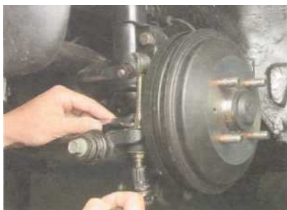
Головкой «на 17» отворачиваем гайку крепления стойки к кулаку, удерживая стойку за шестигранник ключом «на 12».
