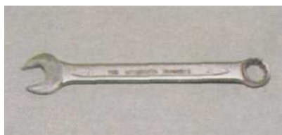
Ключ комбинированный (рожковый — накидной): 6; 7; 8; 10; 12; 13; 14; 16; 17; 19; 21; 22; 23; 24; 30; 36
