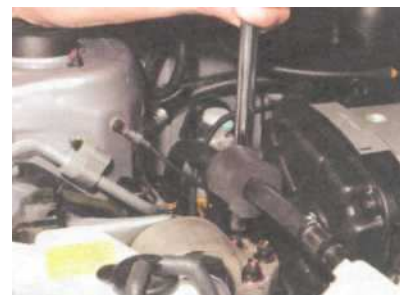
Головкой «на 14» с удлинителем отворачиваем один болт и две гайки крепления опоры к двигателю.
