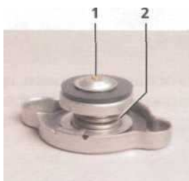
Пробка радиатора: 1 — впускной клапан; 2 — выпускной клапан
