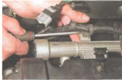
Поддев отверткой два пистона крепления жгута проводов...
