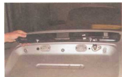
...крестообразной отверткой отворачиваем три самореза крепления накладки крышки багажника...
