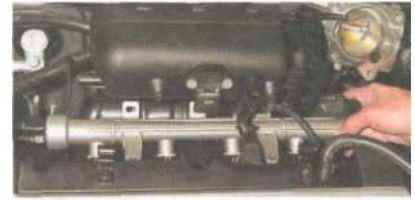
Тянем топливную рампу с форсунками (по оси форсунок), выводя их из отверстий впускного трубопровода.
