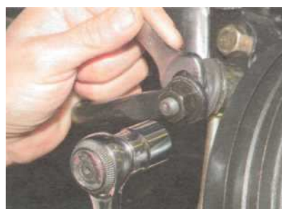
Головкой «на 17» отворачиваем гайку крепления пальца шарнира стойки к штанге стабилизатора, удерживая ключом «на 14» палец от проворачивания.
