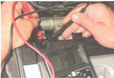
Измеряем сопротивление между выводами форсунки.
