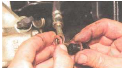
С обеих сторон наконечника установлены медные уплотнительные шайбы.
