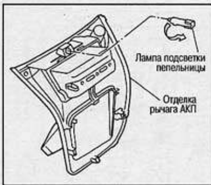
Лампа подсветки пепельницы: 12V 1,8 Вт
